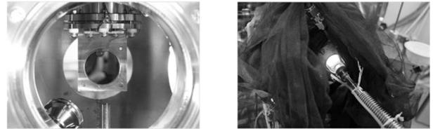
図3 実験装置：星間塵の表面反応を模擬するために、超高真空装置の中に  $-263\text{ }^\circ\text{C}$  まで冷却できる金属基板が設置されている (図4も参照)。
