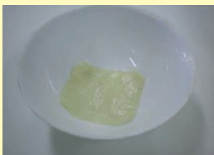
写真1 木綿の布にアニリン、2 mol/L 塩酸をしみ込ませた様子
